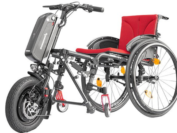
Handbike eléctrica Striker Lomo GX, con rueda de 14" y motor de 1.000 W.
